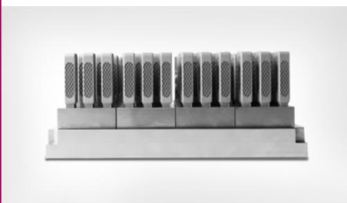
↑ Integrierter Produktions-Workflow in Kombination von additiven und traditionellen Metalltechnologien seitens 3D System und GF Bearbeitungslösungen sowie innovative Software-Lösungen ermöglichten die Produktion dieser Wirbelsäulenkäfige in LaserForm® Titan-Werkstoff.
