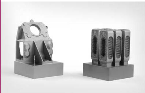
↑ Satellitenhalterung aus Titan (links) und Wirbelsäulenkäfige (rechts) sind mit der DMP Flex 350 perfekt per 3D Druck hergestellt und von der Bauplatte unter Verwendung der neuen CUT AM 500 getrennt.
